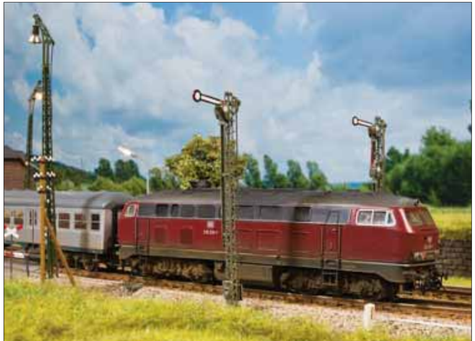
Nahverkehr auf der Kinzigtalbahn in der Epoche IV. 218 230 ist mit einer Garnitur Silberlinge im Personenverkehr im Einsatz. Vom Bahnhof aus gesehen hinter dem beschränkten Bahnübergang stehen die beiden Ausfahrtsignale.
